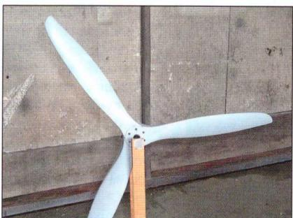
listov. Po vytvrdení epoxidu zalepíme na stred podložky z oboch strán, vyvŕtame otvory pre upevňovacie skrutky a vrtuľa je skoro hotová. Ostáva už len povrchová úprava a hlavne vyváženie.
